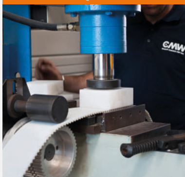
2 Soudure de courroies Belt welding
