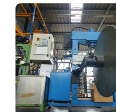
Soudure PU courroies Welding of PU belts
